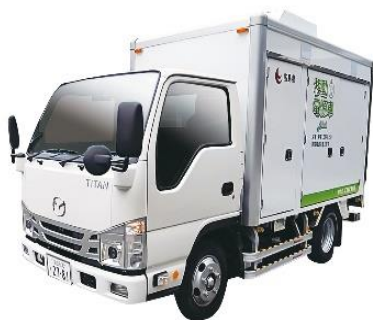
災害現場などで電気を供給する発電機車 (商品名:E-dash)
