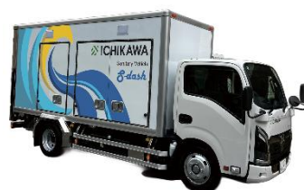
牡蠣殻を使った浄化槽を搭載した 新トイレカー(商品名:S-dash)
