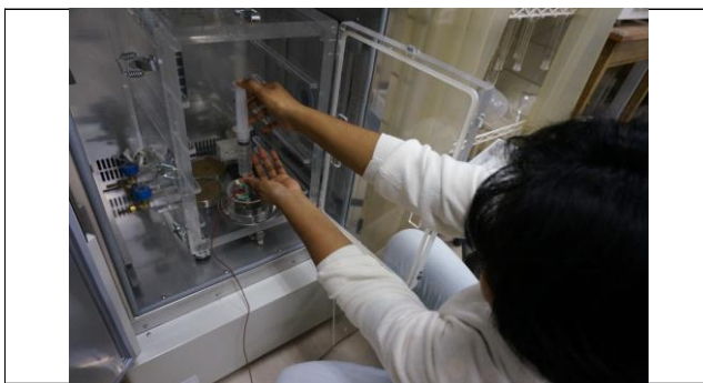
土壌からのCO 2 、 CH 4 ガス発生量把握のためのガスサンプリング/gas sampling for measuring CO 2 and CH 4 emission
