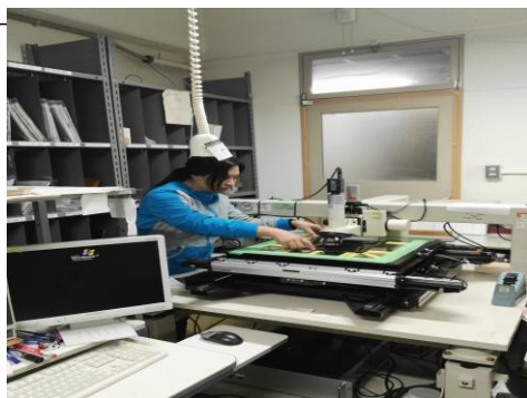
写真乾板を顕微鏡にセットし、顕微鏡画像取得の準備作業である
