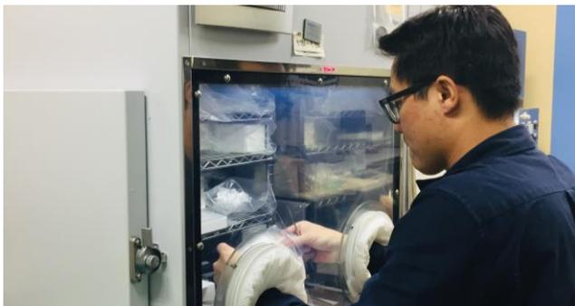
共同観測で得られた大気サンプルの秤量 / Weighing task of particle samples from collaborative air monitoring
