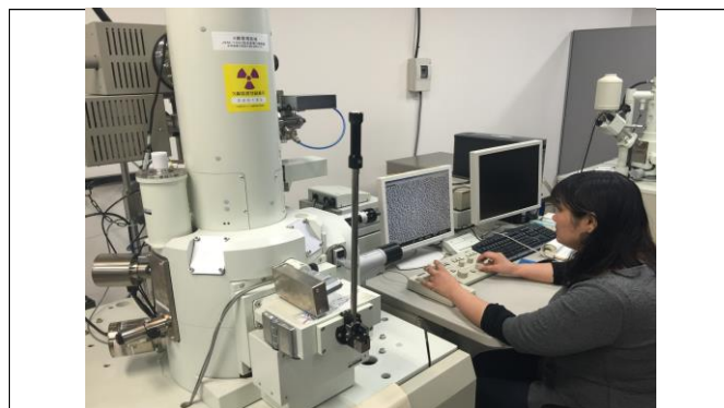
走査型電子顕微鏡(SEM)による試料表面形状観察 /Surface-morphology observation by scanning electron microscopy (SEM)
