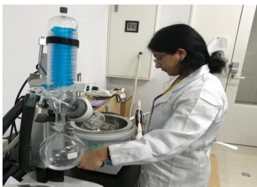
ロータリーエバポレーターを用いた有機物濃縮の様子/Picture with rotary evaporator for the concentration of organic
