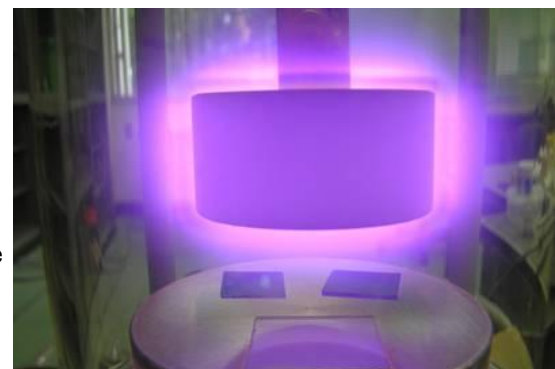
静岡大学におけるプラズマ法に寄る炭素膜合成実験 Carbon-film coating experiment at Shizuoka Univ
