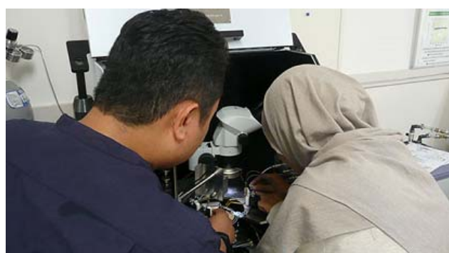
発電性能評価用プローバシステムによる出力電力測定。 Output power characterization using constructed prober system.
