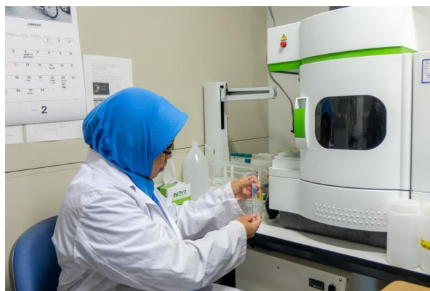
ICP-OESによる原鉱および浸出液中の金濃度分析/ Analysis of gold from raw ore and leaching filtrate by ICP-OES
